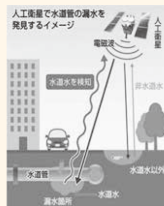
▲人工衛星による漏水調査
